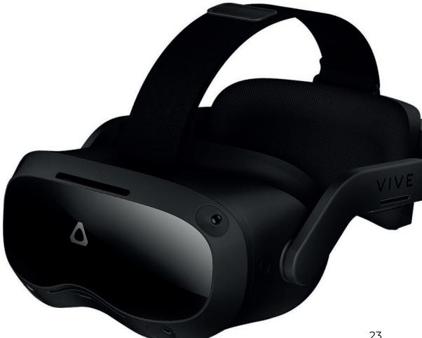
В основу автономной Vive Focus 3 легла однокристальная система Qualcomm Snapdragon XR2. Эта же SoC используется в Oculus Quest 2, однако новинка HTC выделяется на фоне конкурента активной системой охлаждения. Устройство получило такие же экраны, как и Vive Pro 2, единственное отличие – уменьшенная до 90 Гц частота обновления. VR-гарнитура HTC Vive Focus 3 позиционируется в качестве инструмента для решения профессиональных задач и оценена в 1300 долларов.
